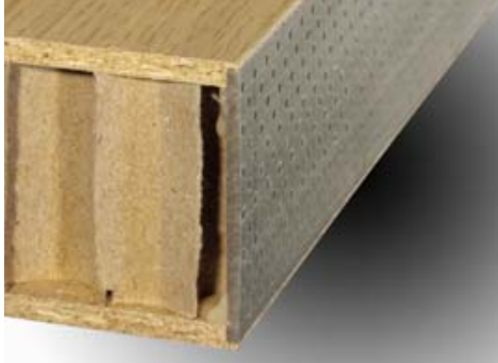
Облегченная строительная плита с покровными слоями 4 мм: в этом случае используются кромки Bonding Edge от Doellken. Опорная кромка вставляется в предварительно отфрезерованные пазы.
